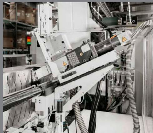
在这套方案系统 (左图) 中,由 MULTILIFT 机械手系统取出通过 FDC 工艺制造而成的导轨 (上图),接着将导轨放到传送带上。纤维被裁切成需要的长度,接着通过侧面输送单元 (右图) 将其送入熔体中。
