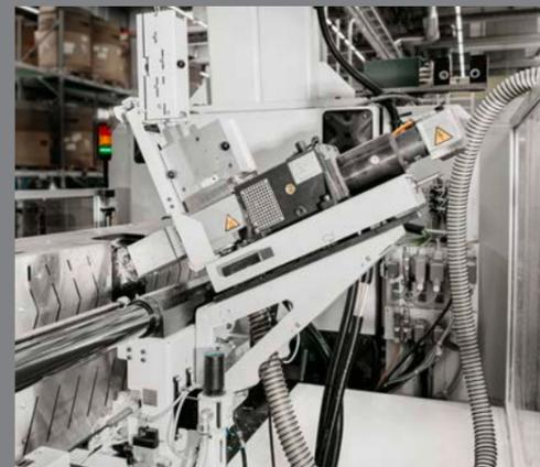
Dans la cellule de fabrication (photo de gauche), les rails de guidage fabriqués avec le procédé FDC (photo du haut) sont prélevés par un système de robot MULTILIFT, pesés puis déposés sur des bandes transporteuses. Les fibres sont coupées à longueur et amenées à la matière fondue par alimentation latérale (photo de droite).
