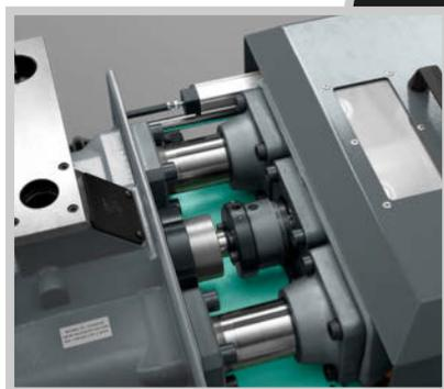
简单的转换：料筒模组喂料单元的中心联轴器和螺杆快速连接器。
