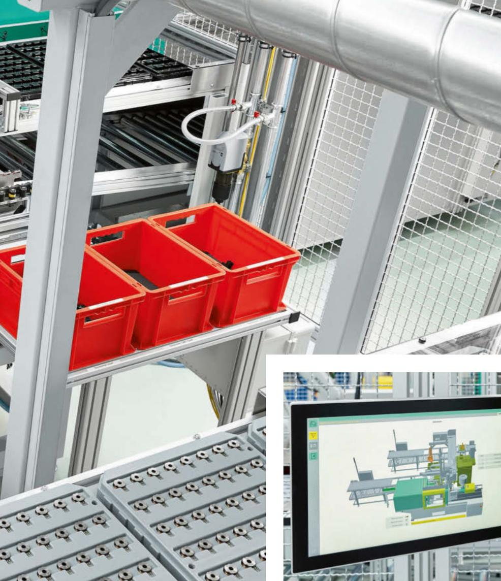
Kendrion utilise une installation clé en main complexe, où des bobines électriques sont surmoulées et contrôlées (grande photo).
