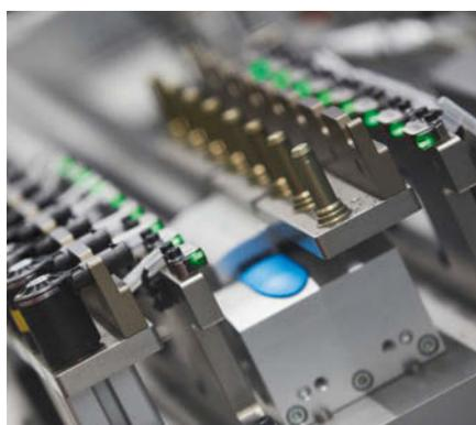
Werner Schleicher, développeur de processus chez Kendrion (photo ci-dessus), est totalement satisfait de la fabrication entièrement automatisée des systèmes excitateurs. Les bobines électriques surmoulées à cet effet sont contrôlées en ligne à 100 %.
