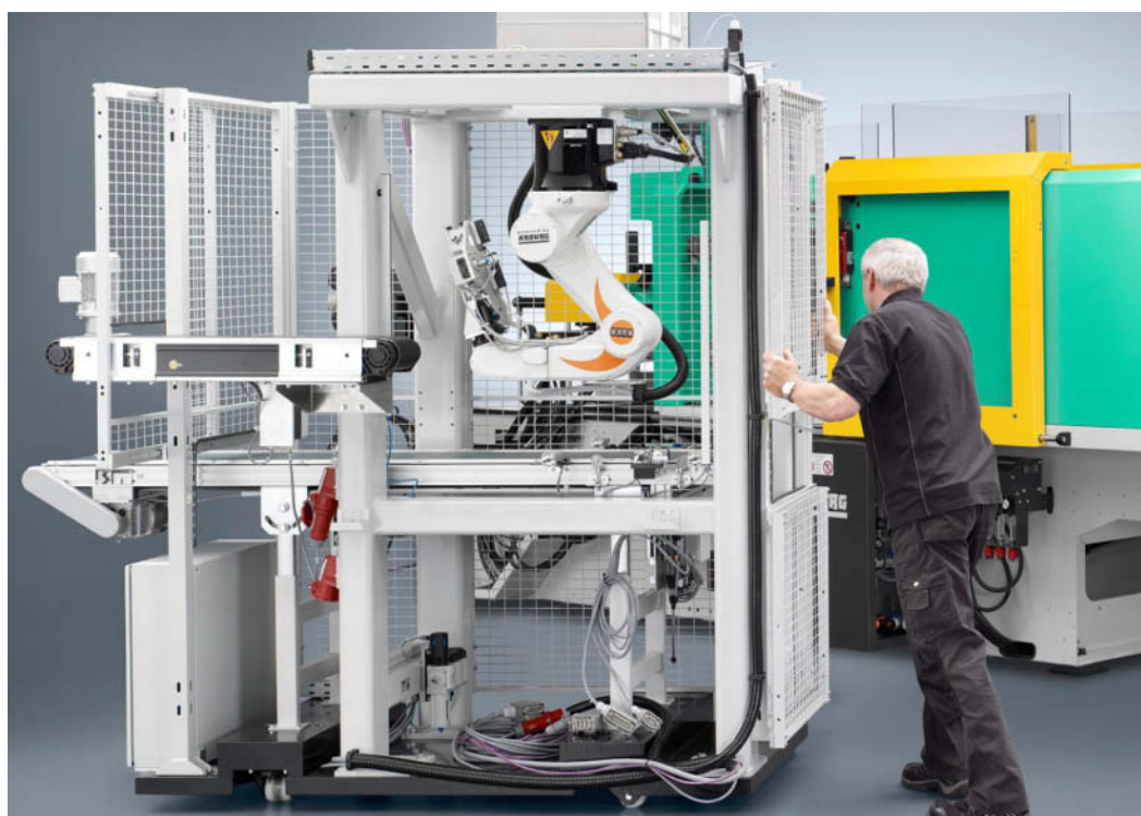
Changement d'emplacement en toute facilité : le module compact peut être déplacé facilement (à gauche). Des idées innovantes : avec plusieurs modules robots mobiles, il est possible de créer des cellules de production entièrement nouvelles (à droite).
