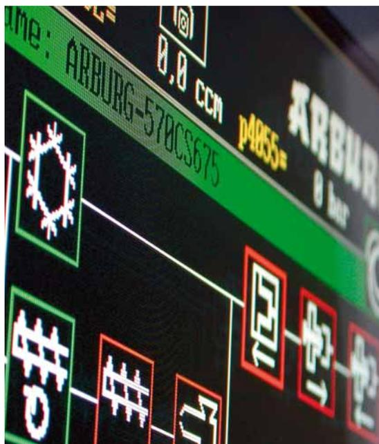
Hier et aujourd'hui : la programmation intuitive des processus sous forme de graphiques simples de la SELOGICA (en haut) et le commutateur à décades pour la commande des processus de la presse sur l'HYDRONICA (à droite).
