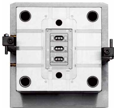
empêche la formation de poches d'air au niveau des fronts d'écoulement et des joints collés. Le point de mélange est simplement déplacé hors de la cavité. Un canal de dégazage souterrain est mis en place lorsque l'agencement du moule, la configuration du canal de refroidissement ou des marques en surface provoquées par le tampon de dégazage le rendent nécessaire. Un tel canal souterrain est conçu comme un morceau de carotte souterraine à point d'injection et éjecteur.
