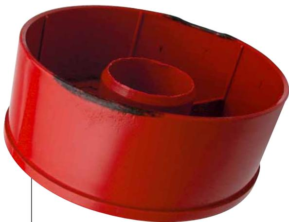
En haut : défaut typique d'une pièce moulée, en raison d'un mauvais dégazage : Traces de brûlures sur le canal d'alimentation.
