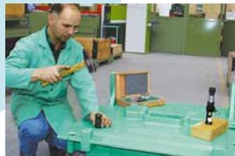
Vérification de la dureté par essai de cisaillement dans le cadre du contrôle de fabrication.
