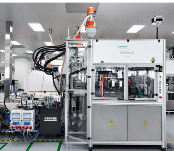
在下游操作中（见上图）将滴壶成品与注射器软管相连接并完成包装。贝朗公司通过将 ARBURG（阿博格）注塑机集成到生产单元的方式，为生产注射治疗软管提供了特殊的解决方案。
