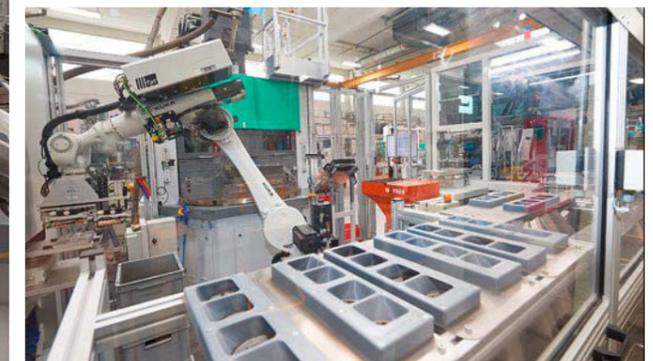
Los tubos de precisión están disponibles en diferentes variantes (foto grande izda.). Los insertos se preparan en la posición correcta mediante sistemas Anyfeeder y un robot Delta, se introducen en el molde para inyección mediante un robot de seis ejes y se sobremoldean en una ALLROUNDER vertical con mesa giratoria (fotos sup. dchas.).
