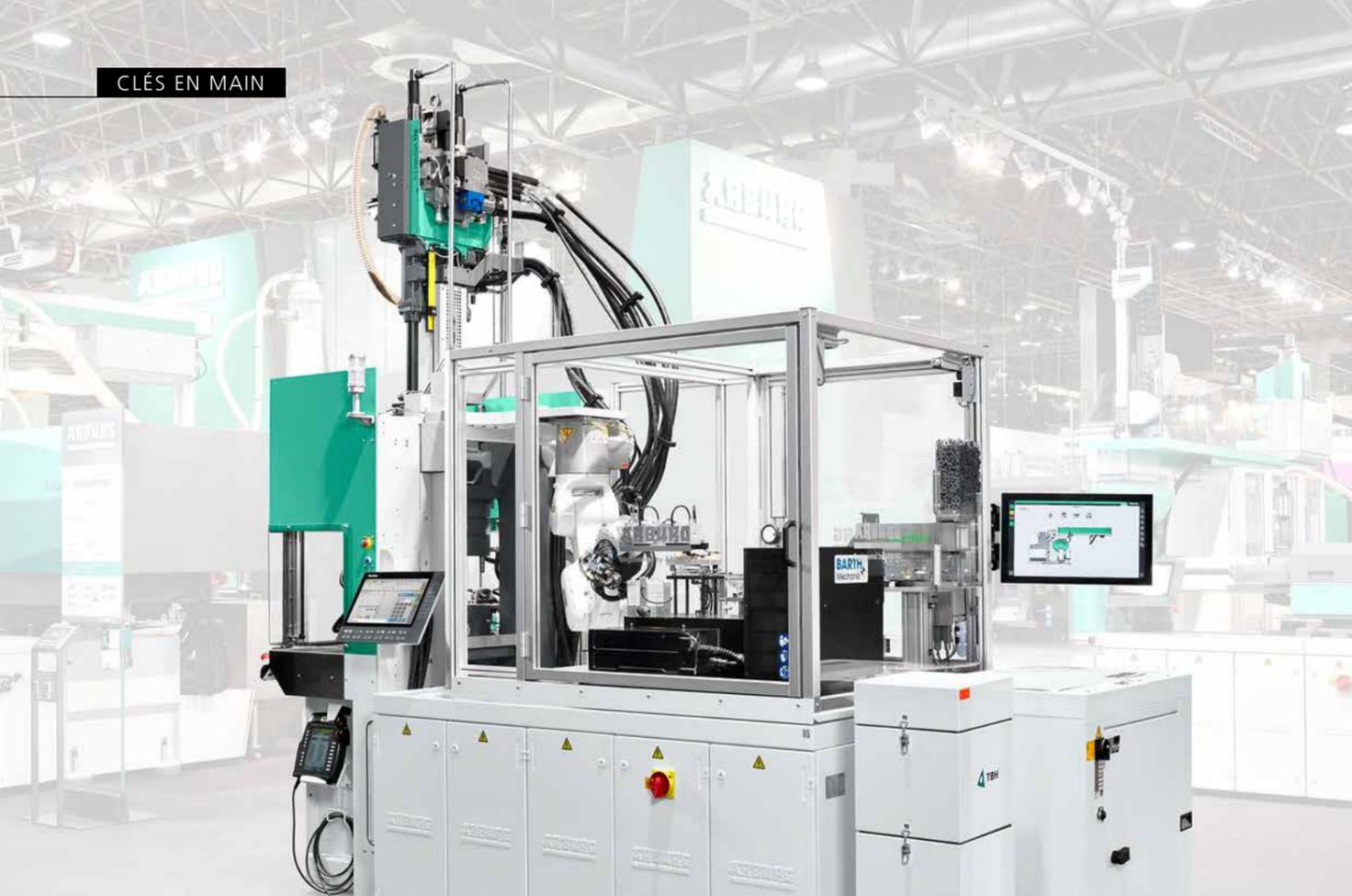
Une cellule de fabrication avec presse ALLROUNDER verticale, robot à six axes et ATCM (photo de gauche) fabrique de manière entièrement automatique un outil pour vélo (photo du bas).
