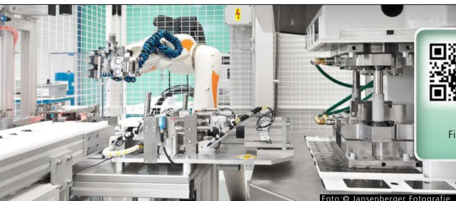
Bei der automatisierten Fertigung von Dilatoren (Bild links) setzt Teleflex auf eine Turnkey-Lösung von ARBURG (Bild Mitte). Ein ALLROUNDER 275 V umspritzt je vier Einlegeteile, das Handling übernimmt ein Sechs-Achs-Roboter.
