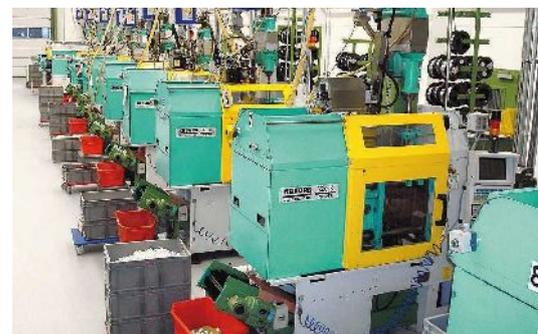
lichere ALLROUNDER investiert. Der umfangreiche Maschinenpark umfasst Spritzgießmaschinen mit Schließkräften von 350 bis 2.100 kN, von denen nahezu alle aus dem Hause ARBURG stammen.
