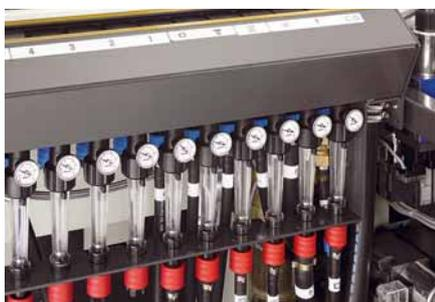
Grâce à la batterie d'eau intégrée (photo de gauche), les différents circuits de refroidissement peuvent être régulés de façon précise via l'interface SELOGICA.
