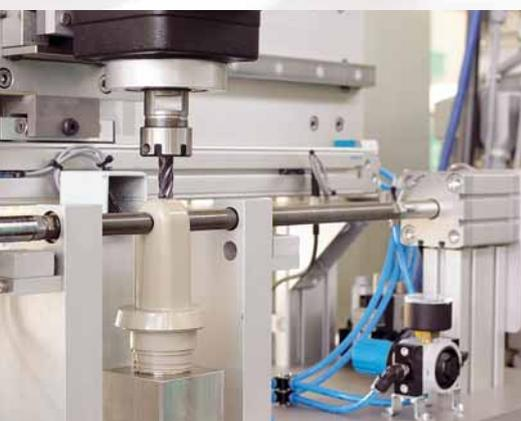
robot retire les pièces préchauffées et les place dans le moule à canaux chauds d'une température de 200 °C. Après le moulage par injection, le pique-carotte intégré à la pince du robot retire la carotte avant que la pièce injectée soit prise et placée dans la station de fraisage pour être traitée. Lors du fraisage du point de carottage, les copeaux sont aspirés directement. Lors de la dernière étape, le produit fini est placé dans les plateaux du système de mise sur palettes.
