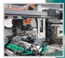
Rapidité et précision : rotation électrique de 120° à chaque fois des cavités d'un moule pour l'injection polycomposant.
