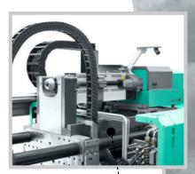
Position sur plateau mobile (M) : deuxième unité de fermeture se déplaçant au-dessus du plateau mobile de bridage du moule.
